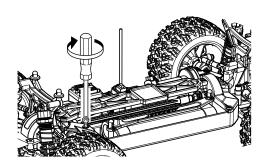
▶定期的に、各部のビス類が緩んでいないか確認してください。 Check all screws, nuts etc. on a regular basis for looseness Überprüfen Sie regelmäßig alle Schrauben, Muttern usw. auf festen Sitz. Vérifiez régulièrement la visserie.
