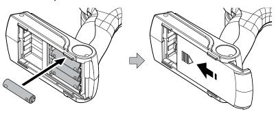
\*NOTE: Oxyride batteries cannot be used! \*NOTE: Ne pas utiliser de batteries de type OXYRIDE.
