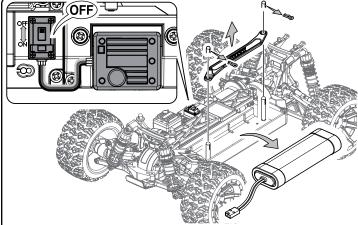
▶走行後や、走行させない時は必ず電源スイッチをOFFにし、車体と送信機の電池 を取り外してください。誤作動や電池の発熱・液漏れなど危険な場合があります。 Always switch off the receiver and transmitter, then disconnect/remove the batteries when the model is not in use. Failure to do so may cause damage to the batteries
