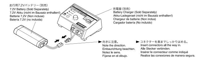
**2** シャシーの準備 / Chassis Preparation / Aufbau des Chassis / Préparation du châssis / Preparación del chasis
